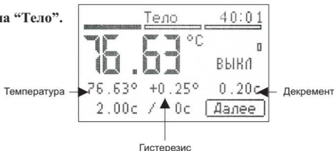
На этапе “Тело” три дополнительных параметра: “Температура” (Th), “Гистерезис” (Td), “Декремент”. К этапу “Тело” переходят после стабилизации температуры на предыдущем этапе, а параметр “Температура” устанавливается равным текущей температуре на момент перехода.
