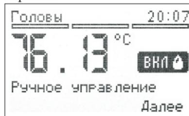
Кнопка ОК переключает состояние клапана, кнопки Вверх/Вниз выходят из режима ручного управления.
