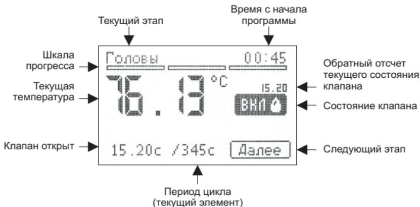
Навигация между элементами экрана стрелками Вверх/Вниз. Кнопка ОК на параметре - вход/выход режим редактирования. В режиме редактирования кнопками Верх/Вниз меняется значение (при удерживании ускоряется). Кнопка Далее - переход к этапу “Тело”.
